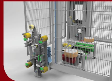
Aufnahmebügel für drehbaren Bottich
